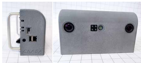
Inspektionsgerät: Simultane Nutzung von Stereokamera und Time-of-Flight (TOF) Sensor gestatten eine robuste Erfassung der 3D-Formen (Rohre und Flansche) auch unter schwierigen Lichtsituationen.
